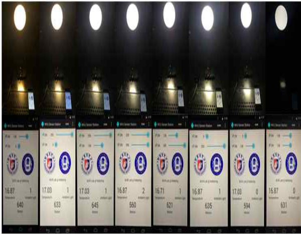
그림 9. 어플리케이션을 통한 색온도 변화 Fig. 9. Color temperature change through the application
