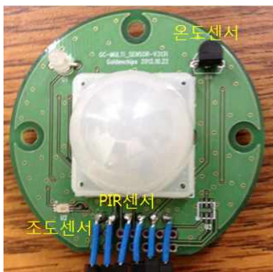
그림 5. 멀티센서(골든칩스 社) Fig. 5. Multi-Sensor Module(Golden Chips. Ltd.)
