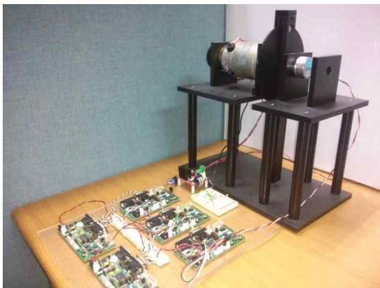
그림 10. 제작된 아라고 원판 시스템 Fig. 10. Designed Arago's Disk system
