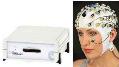
그림 2. EEG 측정을 위한 BrainAmp(좌)와 actiCap(우)[4]
