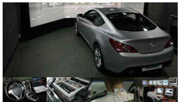
그림 6. 운전자가 스트레스와 관련된 생리 신호 측정을 위한 실험 환경 KMU DS-5[15]
