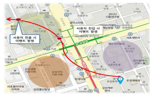
그림 3. 지오펠스의 기본 동작 Fig. 3. The basic operation of the geofence.
