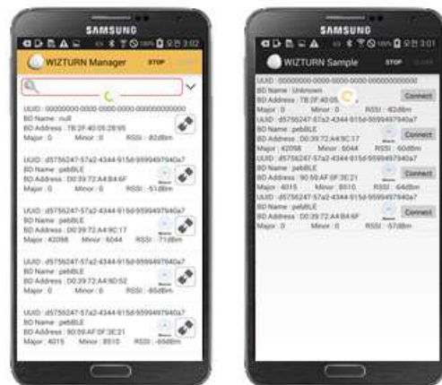
그림 7. 비콘 관리 및 스캔 애플리케이션 Fig. 7. Beacon management and scanning application.
