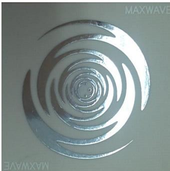
그림 4. 설계 제작한 시뉴어스 안테나
