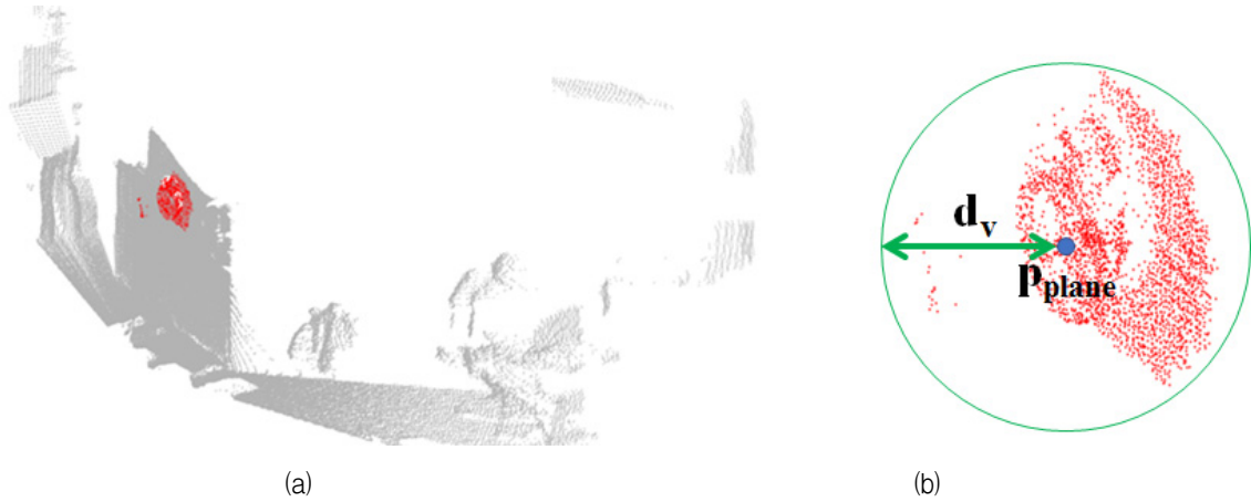
그림 4. LIDAR로 수집한 3차원 점군 데이터. (a) 전체 모습. (b) 밸브 부분만 추출한 점군 데이터. Fig. 4. 3D point cloud obtained LIDAR. (a) whole points. (b) a part of points represents valve.
