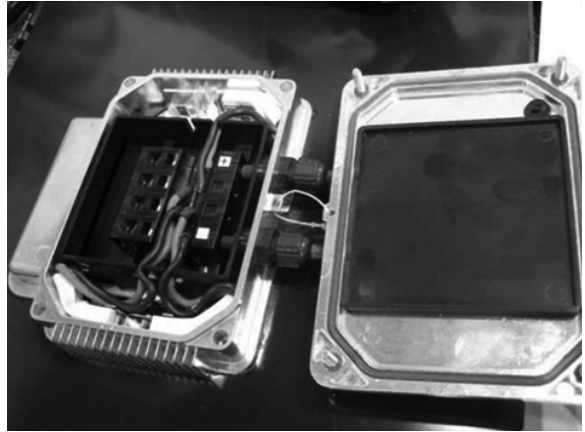
[그림 5] Schott의 G to G type 모듈과 FPE의 Heat sink를 적용한 알루미늄 Junction Box(Schott 2009, FPE 2009)
