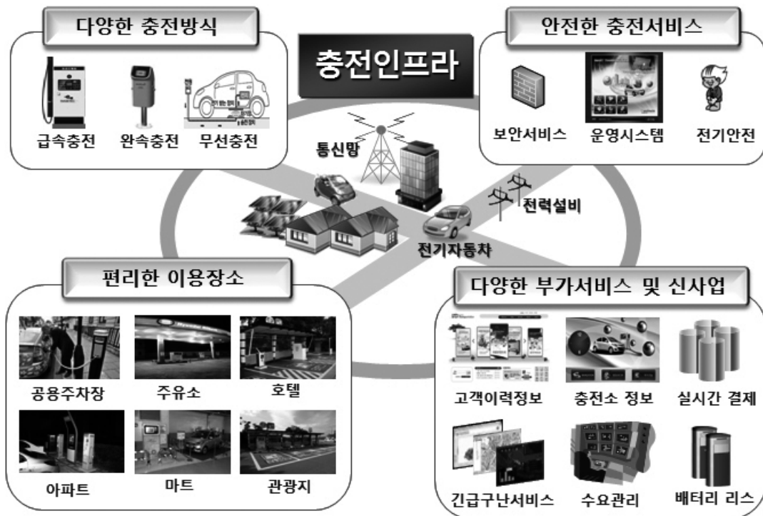
[그림 1] 전기차 충전인프라 구조도
