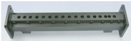
그림 12. 제작된 X 대역 송신 필터 (길이 : 215mm)
