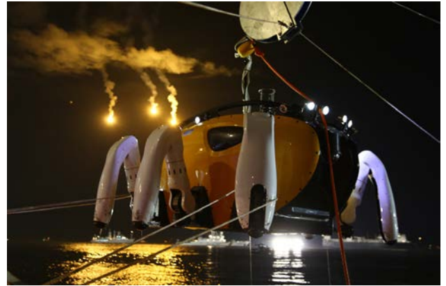
▶▶ 7. 세월호 선체의 수중 촬영을 마치고 인양되는 크랩스터 CR200: 4월 23일 20시30분부터 약 2시간 30분 동안 세월호 북서쪽 100~70m 지점에서 침몰한 세월호의 선체를 스캐닝소나를 이용해 촬영했다.
