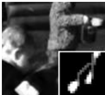
▶ (왼쪽) 흔들린 영상 (오른쪽) 복원된 영상과 흔들림의 궤적 출처 : Levin, A. et al. "Understanding and evaluating blind deconvolution algorithms.", CVPR 2009. IEEE Conference on. 2009. 1964-1971
