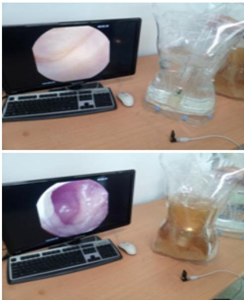
그림 10. 무선 내시경을 이용한 임상(팬텀) 실험
