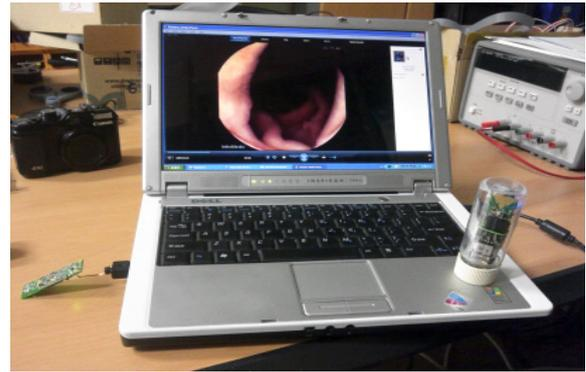
그림 6. 무선 내시경을 이용한 영상 데이터 전송 시연
