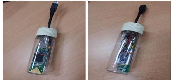
그림 7. Canon G10 카메라를 이용한 영상 데이터 전송을 위한 UWB 통신 패키지 모듈
