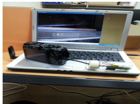
그림 8. UWB통신 패키지 모듈을 이용한 Canon G10 카메라 영상데이터 무선 전송 시연
