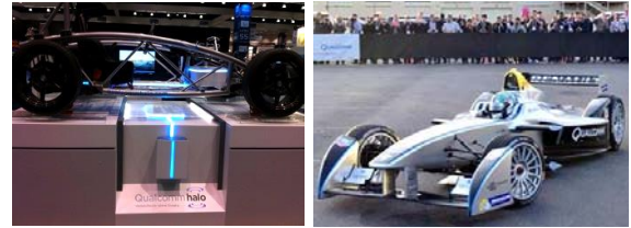
(그림 8) Qualcomm Halo의 자기유도 전기자동차 무선충전
