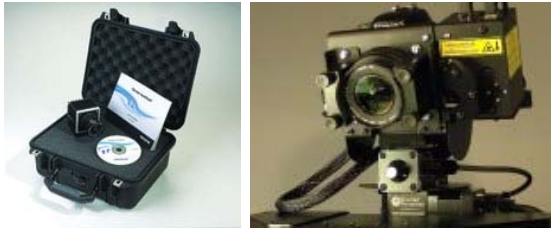
(그림 4) 멀티 프로젝터 자동보정 도구[7][8]
