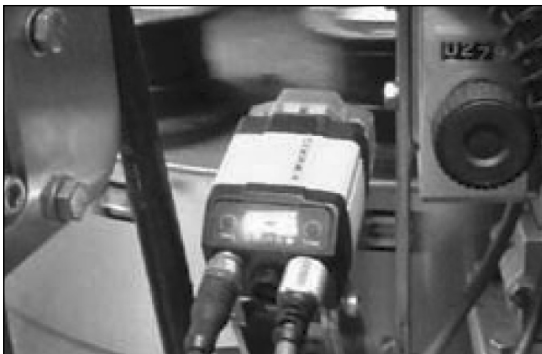
[사진 3] DataMan 300은 또한 PLC 및 공장 네트워크와 손쉽게 통신할 수 있는 통합 이더넷을 제공한다.
