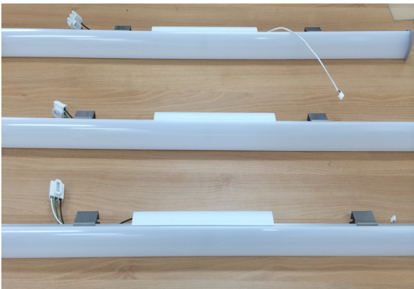
그림 1. 실험에 사용된 LED 형광등과 안정기
