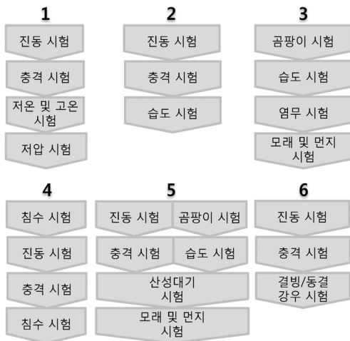
<그림 2> MIL-STD-810G를 바탕으로 한 시험순서 가이드라인 제시
