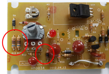
<그림 3> 과전압 시험 후 저항 탄화시료
