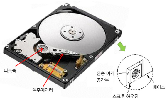
<그림 4> 스크루 하우징의 완충 이격 공간부 마련을 통한 HDD의 신뢰성 확보
