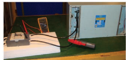
〈그림 9〉 누설전류 측정구성도(上) 및 시험장면(下)
