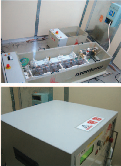
〈그림 7〉 HEMP PCI 단펄스(上) 및 중펄스(下) 시험장면
