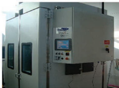
〈그림 11〉 열충격 시험 온도 프로파일(上) 및 시험장면(下)
