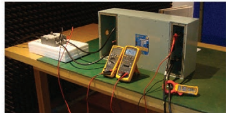
〈그림 8〉 전압강하 측정구성도(上) 및 시험장면(下)
