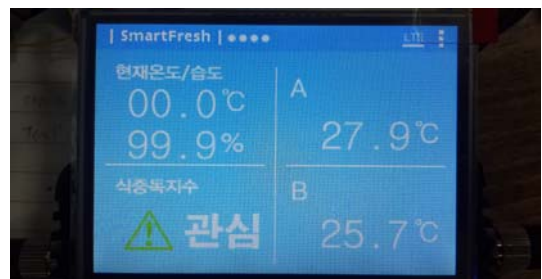
그림 5. 단말기 구동 화면 Fig. 5. 320*240 TFT-LCD preview.
