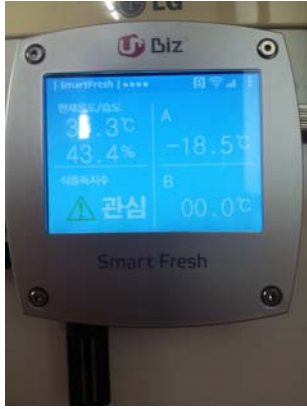
그림 6. Smart HACCP 단말기 Fig. 6. WCDMA-LTE terminal for smart HACCP.
