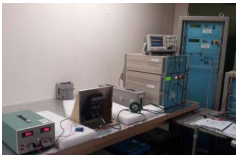
그림 16. 케이블 유도 시험 사진 Fig. 16. The photo of cable induction test.
