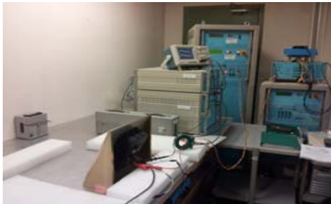
그림 14. 직접주입 시험 사진 Fig. 14. The photo of direct injection test.
