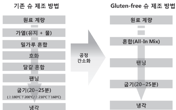
그림 17. 기존 공정과 슈스타 적용 슈 제조 공정의 비교
