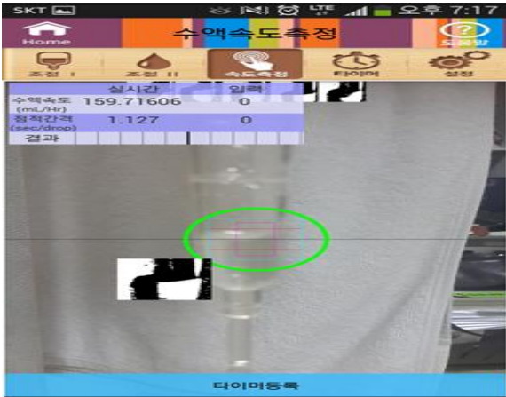
그림 10. 수액 속도 측정하는 모바일 응용 프로그램 Fig. 10. Mobile application for the drip speed measurement
