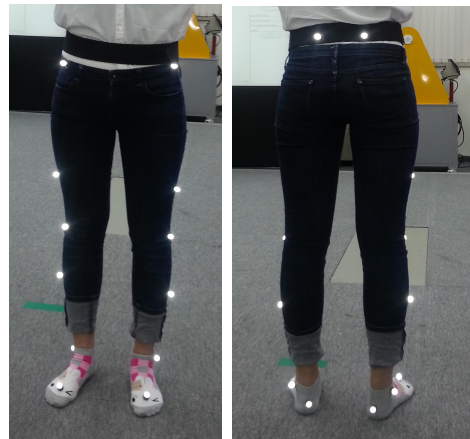
그림 3. 보행분석 실험을 위해 반사체를 접착한 모습 Fig. 3. Attachment of detectors for gait analysis experiments
