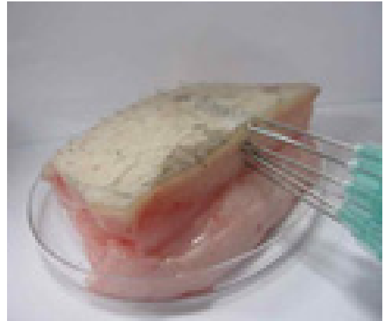
그림 3. 돼지 조직을 이용한 조직 깊이별 온도 측정 Fig. 3. Thermal measurement using pig's tissue on different deeps.
