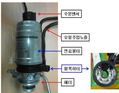
Fig. 1. The composited fuel filter and heater 그림 1. 통합연료필터와 블록히터
