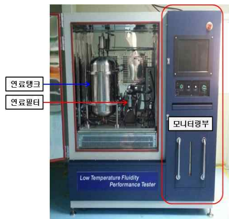
Fig. 3. Low temperature fluidity system 그림 3. 저온유동성 시험장치
