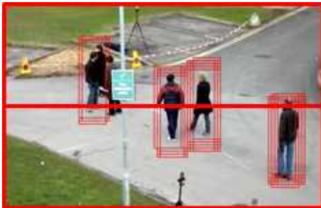
Fig. 7. Parallel processing implementation of pedestrian detection based on ROI-CENTRIST (even frame) 그림 7. ROI-CENTRIST 기반 보행자 인식의 병렬처리 구현 (짝수 프레임)
