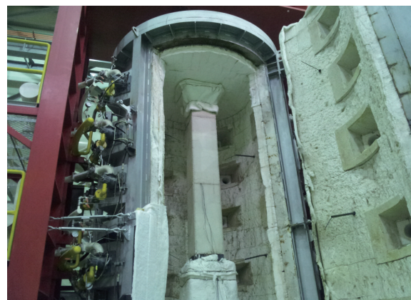
사진 1. 기둥가열로 시험체 설치
