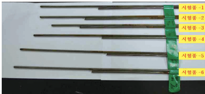
사진 4. 응력부식 시험 후 강선
