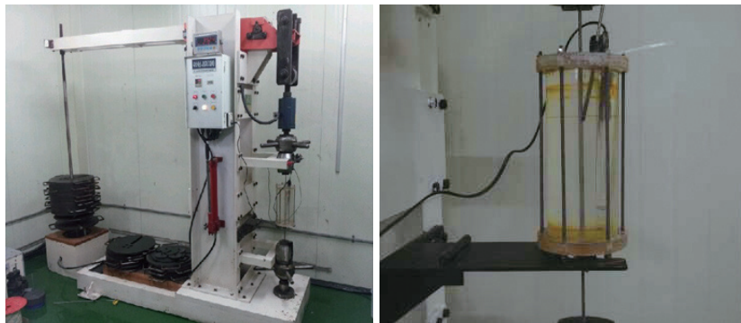
사진 2. 응력부식 시험 전경(고려제강)
