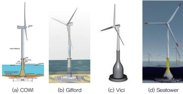
그림 1. 중력식 콘크리트 지지구조 개발 사례
