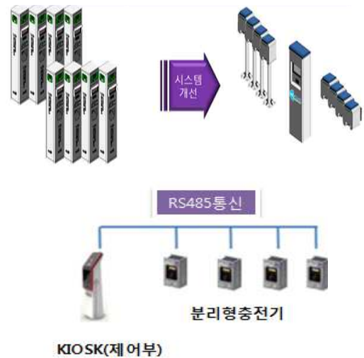
그림 3. 멀티 충전 시스템 구조도 Fig. 3. Structure of multi-charging system.
