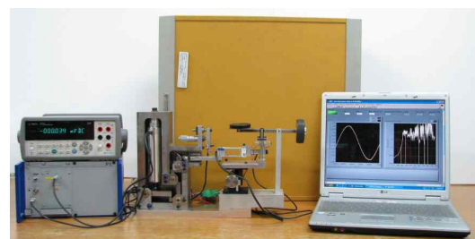
그림 2. 프레팅 부식 테스터의 실험 장비 Fig. 2. The experimental equipment of the fretting corrosion tester.
