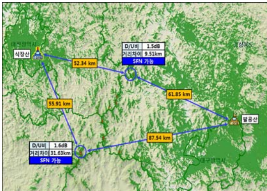
그림 8. 식장산과 팔공산 송신소의 SFN 구성 가능 여부 분석 Fig. 8. Possibility verification of SFN composition of Sikjangsan and Palgongsan transmitter
