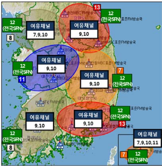
그림 5. 전국 SFN 구성 및 여유채널 Fig. 5. National SFN composition and available channels
