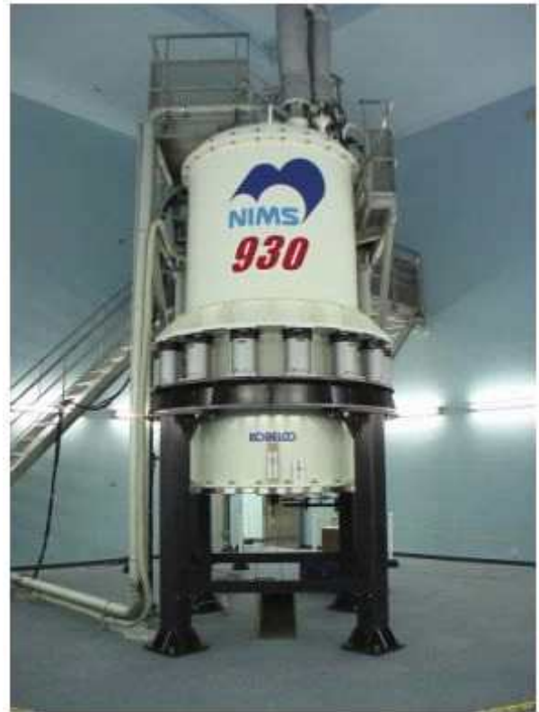
그림 2. 930MHz NMR용 초전도 마그넷의 외관.
