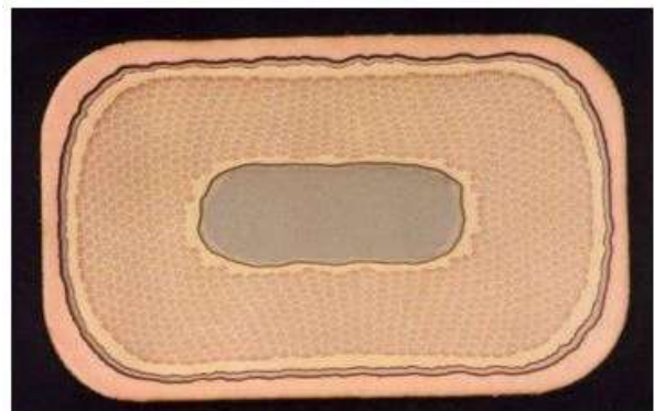
그림 1. Ta보강재를 적용한 Nb 3 Sn선재의 단면.
