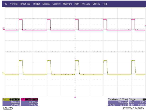
그림 5. 실험 결과 (CH1-황색_아래: 출력전류(100A/div), CH2-적색_위: Trigger 신호)
