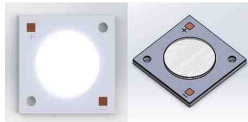
그림 1. 13.5W COB LED 3D 형상 설계 Fig. 1 3D shape design of 13.5W COB LED
