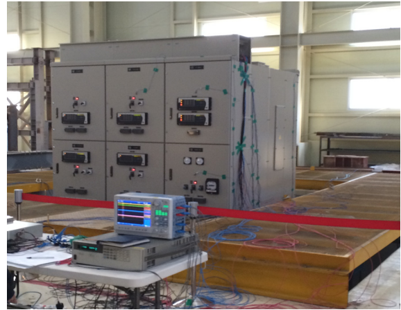
<그림 3> 내진시험 수행모습
