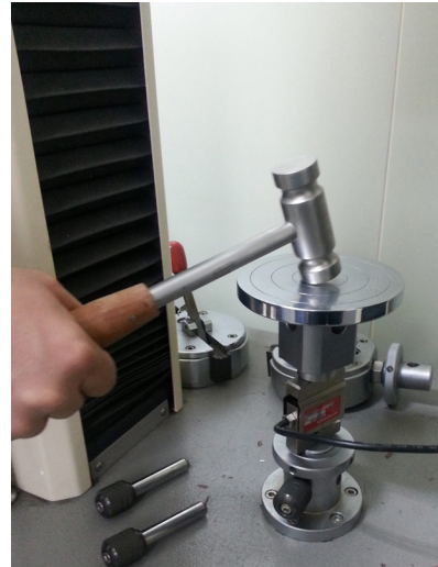
<그림 5> 망치로 인한 충격량 측정
