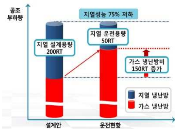
그림 11. 냉난방 설비 운전현황 Fig. 11. HVAC Equipment Operation Status
