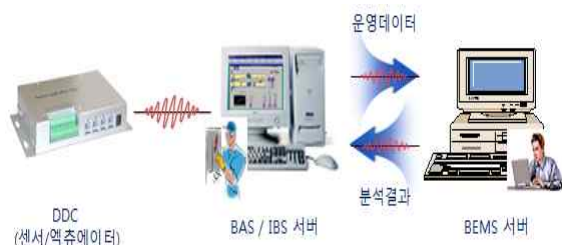
그림 6. BAS 및 IBS 서버 연계 모델 Fig. 6. A Model for BAS & IBS Server Grid Model
