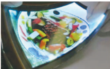
Fig. 7. 산화물 반도체 TFT를 이용하여 구현한 3.5인치 플렉시블 AMOLED 제품.
