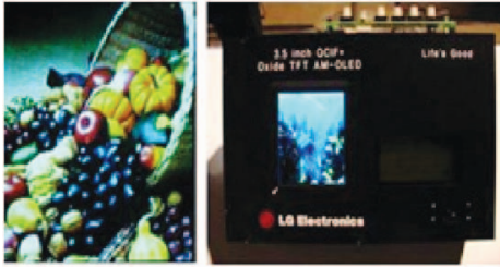
Fig. 6. 산화물 반도체 TFT를 이용한 3.5인치 AMOLED 패널. 11)
