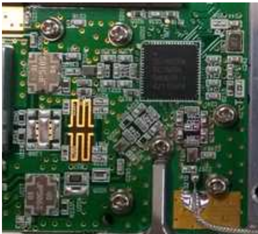
그림 7. 제작된 신테라 선형화기 (SC1889A) Fig. 7. Fabricated Scintera linearizer (SC1889A).
