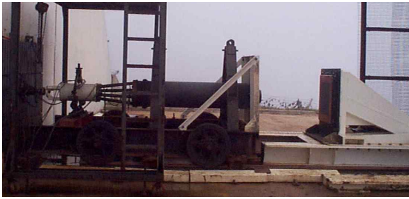
Fig. 5. Jet impingement test
