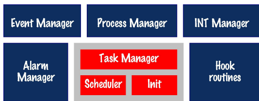
그림 3. PICOS18의 계층구조. Fig. 3. Hierarchical structure of PICOS18.
