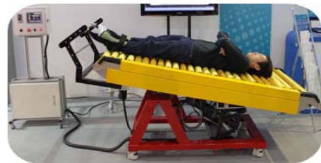
그림 2. 견인 시스템의 구현. Fig. 2. Implementation of the traction system.
