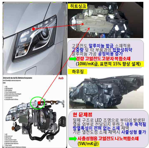
그림 4. 자동차용 LED 헤드램프 방열기구 문제점
