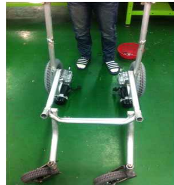
그림 13. 제작된 휠체어가 접힌 측면모습
