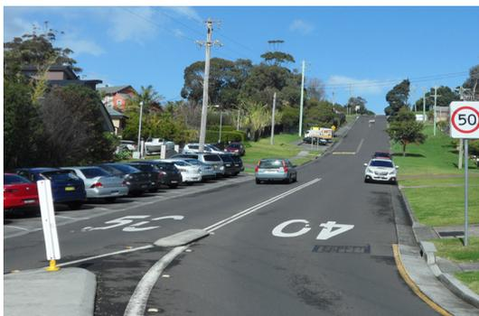
그림 4. 구간조건에 따른 주행속도 상하행 차등 적용(50km/h→40km/h)
