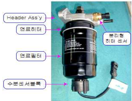
Fig. 3. Separated fuel heater 그림 3. 분리형 연료필터
