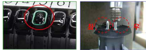
Fig. 11. Cavity reform of heater connector 그림 11. 통합히터의 커넥터 이탈력 보정
