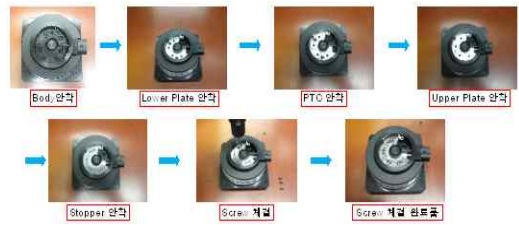
Fig. 2. Body assembly process of unified heater 그림 2. 통합히터의 바디부 조립공정
