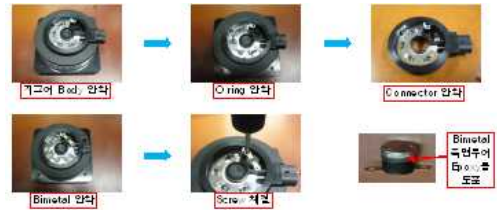
Fig. 3. Bimetal assembly process 그림 3. 바이메탈 조립공정
